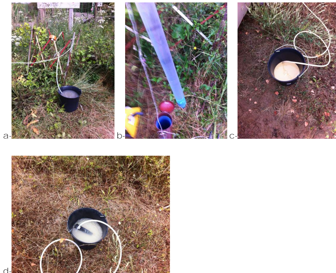
Figure 5 : Observations hydrogéologiques : a- PZ3ac ; b-PZ3 ; c-PZ4ac (début de purge) ; d- PZ4ac (fin de purge) - (IDRA – 2016)
